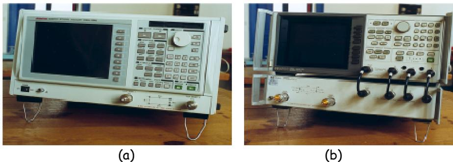
*Figure 6 - Analyseurs de réseau vectoriels*
