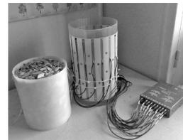
*Dispositif d'imagerie d'une section de pipeline par tomographie capacitive (gauche). Capteur pour la mesure du taux d'humidité dans le bois et son électronique de mesure (droite).*
