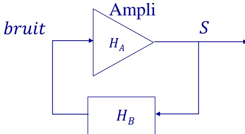
→ Le circuit oscille à la fréquence  $f$  telle que  $H_A(f) \cdot H_B(f) = 1$
