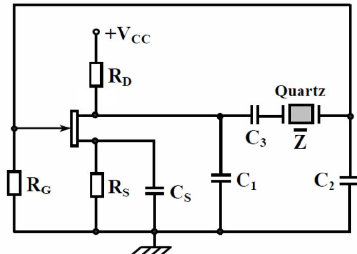
Oscillateur stabilisé à quartz
