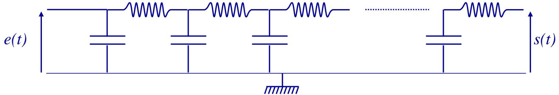
et on simule les inductances par des circuits actifs sans utiliser de self
